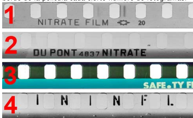
Figura 63. Marcas de identificación del tipo de soporte
