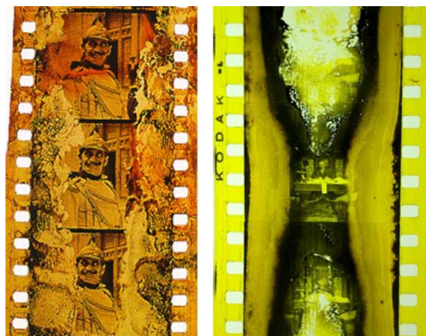
Figuras 4 y 5. Destrucciones muy graves de origen exógeno.
