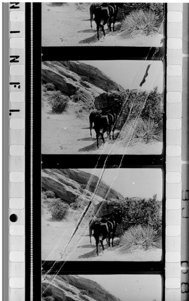
176.1. Desgarro reparado en negativo y reproducido en copia.
