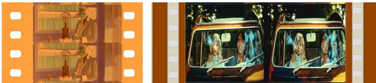
Figura 109. Formatos 3D. Sistemas de luz polarizada: negativo de imagen en 35mm de dos perforaciones y copia estándar en 70mm de fotograma partido.
