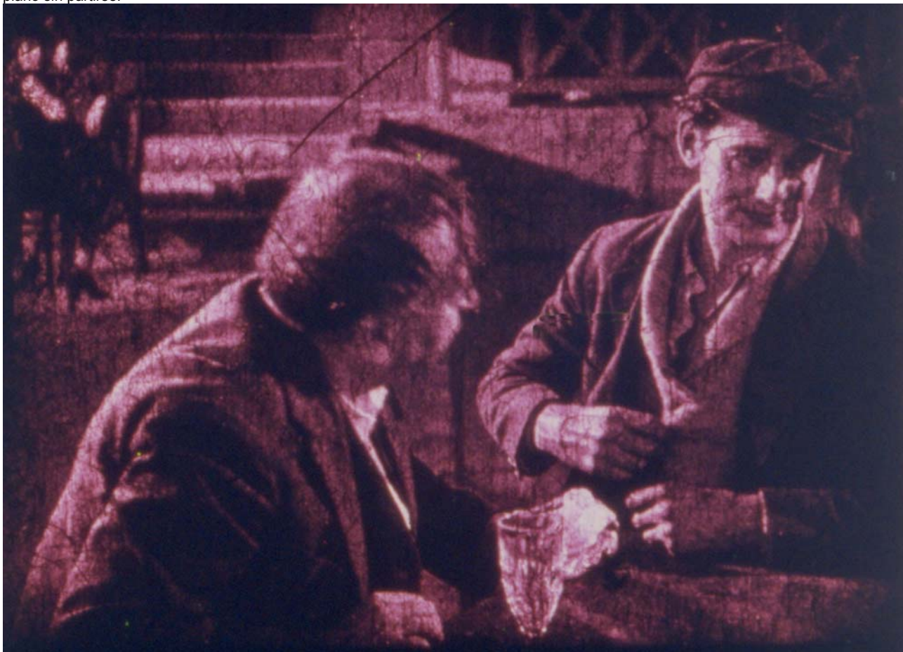
Figura 168. Craquelación. La contracción de soporte y emulsión produce grietas en toda la cara emulsionada.
