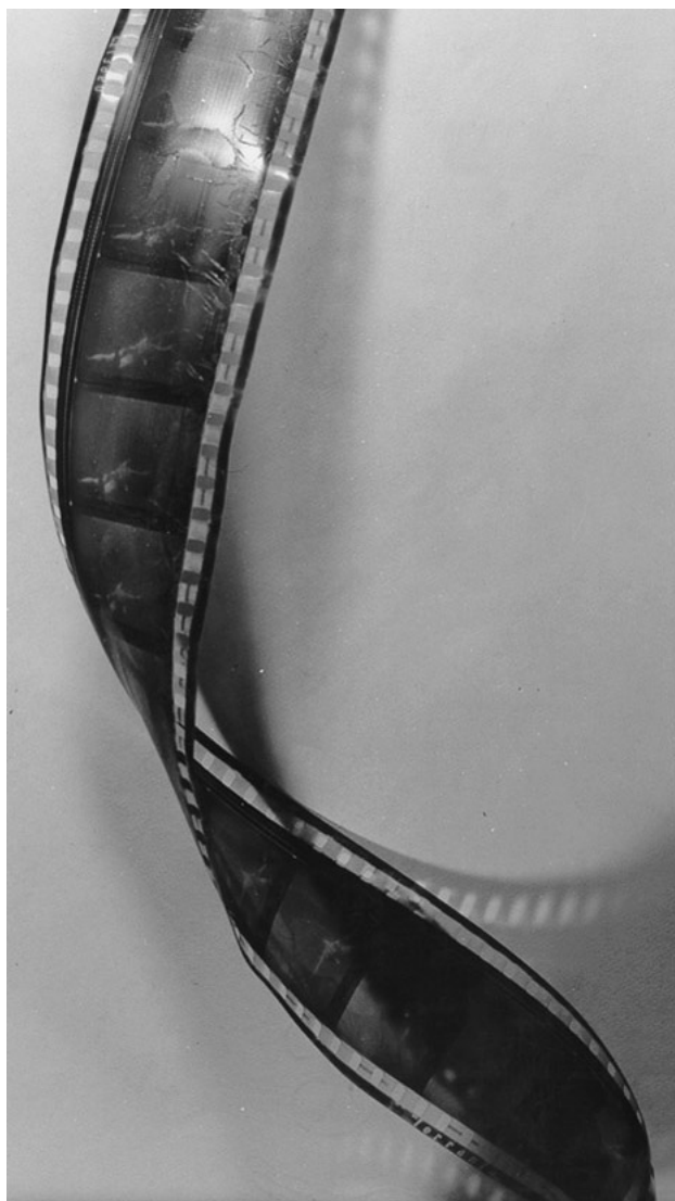
Figura 12: Película rígida y deformada por la degradación acética
