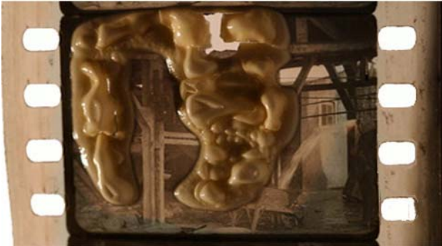
172.1. Quemadura de ventanilla en una película de celuloide.
