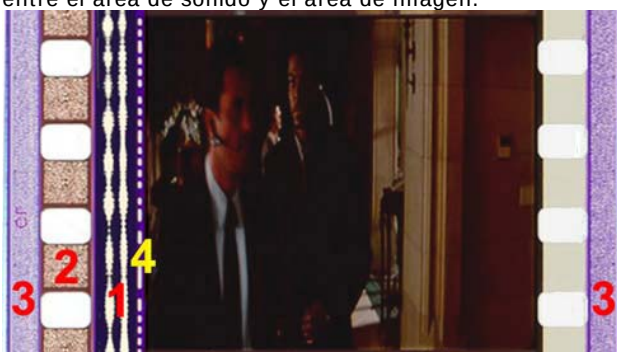
Figura 119. Sistemas estereofónicos de sonido óptico [1] Pista analógica estereofónica. [2] Banda Dolby digital SR-D en los espacios Inter-perforaciones. [3] Pistas de la banda Sony SDDS sobre los bordes de película. [4] Código D.T.S. entre el área de sonido analógico y el área de imagen.
