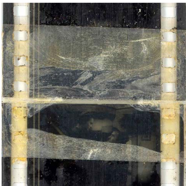
176.3. Cinta autoadhesiva degradada en un empalme en copia.
