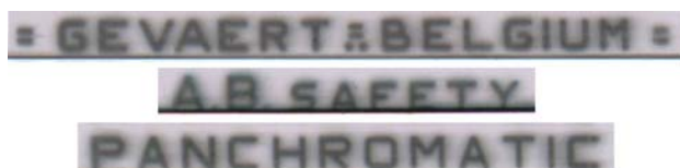
Figura 69. Identificación Acetato Butirato en una película negativa Gevaert de 35mm.
