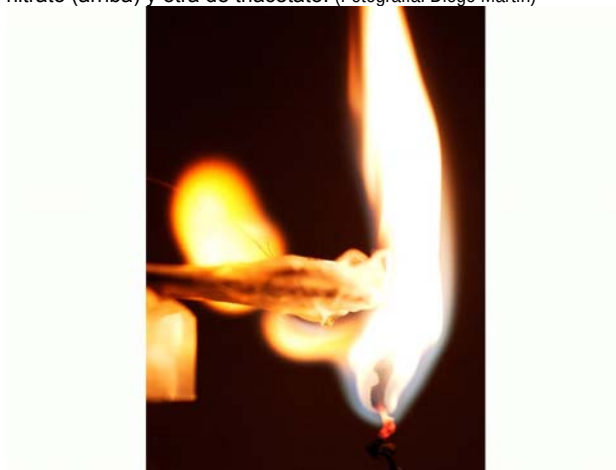
Figura 68. Muestras de nitrato (izquierda) y triacetato ardiendo simultáneamente. Para conseguir este efecto fue necesario utilizar una muestra de triacetato de mayor tamaño. (Fotografía: Diego Martín)
