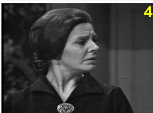
Figura 59. Desarrollo de un Dropout en 4 imágenes sucesivas. (Prueba preparada por el Centro de Documentación de RTVE)
