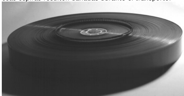
Figura 179. Enrollado defectuoso con una espira sobre la superficie del rollo. (Fotografía: Diego Martín)
